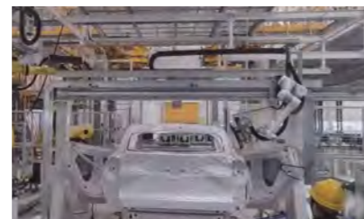
Montage von Autotüren und Karosserieteilen
