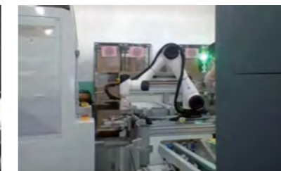
Beladen/Entladen der Klebespritzmaschine
