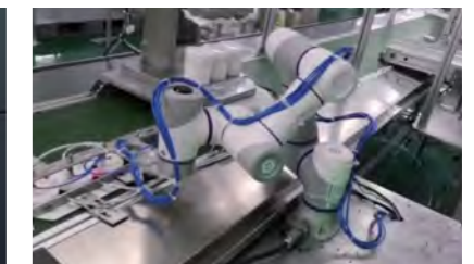
Beladen/Entladen von Kunststoffdeckeln
