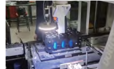
Verschraubung von Energiespeicherbatterien
