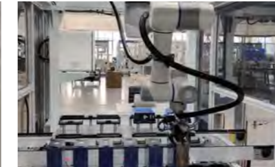
Beladen und Entladen von Batterietests
