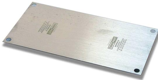
Das Record-Klischee ist ebenfalls eine Entwicklung aus dem Hause TAMPOPRINT. Gefertigt aus Bandstahl mit einer Härte 54Rc eignet es sich bestens für Druckmotive mit feinsten Schriften, Linien und Rasterungen. Beim Einsatz von mittleren bis hohen Laufleistungsanforderungen stellt es eine kostengünstige Alternative zum Vollstahl-Klischee dar.
