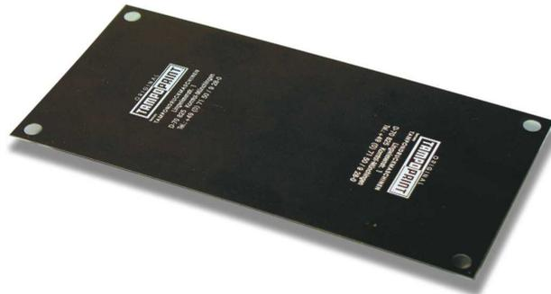
Dieses neu von TAMPOPRINT entwickelte Klischee verbindet die Vorzüge der lasergravierfähigen Aloxid-Klischees mit der mechanischen Stabilität eines magnetischen Stahlblechträgers. Das Motiv entsteht bei uns durch Schichtabtrag mittels Laser mit äußerst präziser Gravurtiefe und Konturschärfe.
