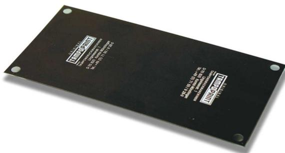
Bei dem von TAMPOPRINT speziell für die Lasergravur entwickelten Aloxid-Klischee handelt es sich um ein Aluminiumklischee mit Hightech-Eloxalbeschichtung. Das Motiv entsteht bei uns durch Schichtabtrag mittels Laser mit äußerst präziser Gravurtiefe und Konturenschärfe. Ein Klischee, das sich besonders hervorhebt durch die ideale Kombination aus Spitzen-Laufleistung und niedrigem Preis.
