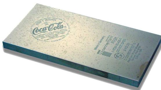
TAMPOPRINT Stahl-Klischees werden aus hochwertigem, korrosionssicherem Chromstahl (Härte 63 Rc) gefertigt. Durch spezielle Umgussverfahren und einen hohen Chromanteil hat sich unser Stahlklischee seit vielen Jahren aufgrund seiner Qualität einen hohen Marktanteil gesichert. Sehr hohe Laufleistungen können problemlos erreicht werden.
